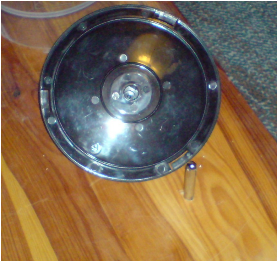
Abb. 3: Der Zapfen lässt sich nur noch mit viel Kraft lösen und die Rundung an der Oberseite stellt ein Gefahrenpotential weniger dar.
